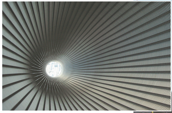
Der neu eingesetzte Wickeldrahtfilter Foto: Manfred Piewak
